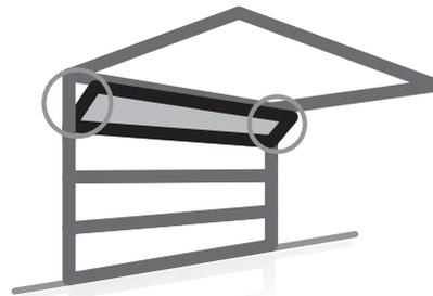
In diesem System kann das obere Paneel gekippt werden, ohne das das Tor gehoben werden muss. Das untere Paneel liegt am Boden an.
