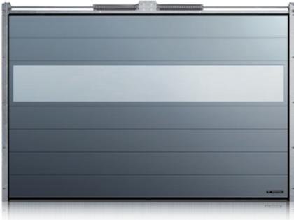
Aluminiumpaneel ohne thermische Trennung, mit transparenter Acrylscheibe ohne Sprossen. In einem Tor kann maximal eine VISUAL-Verglasung eingesetzt werden. Erhältlich für Tore in der Breite von So-3000 [mm]. Keine Anwendung mit Schlupftür möglich.
